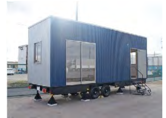
車検取得しナンバープレートを取り付けたトレーラーハウス
