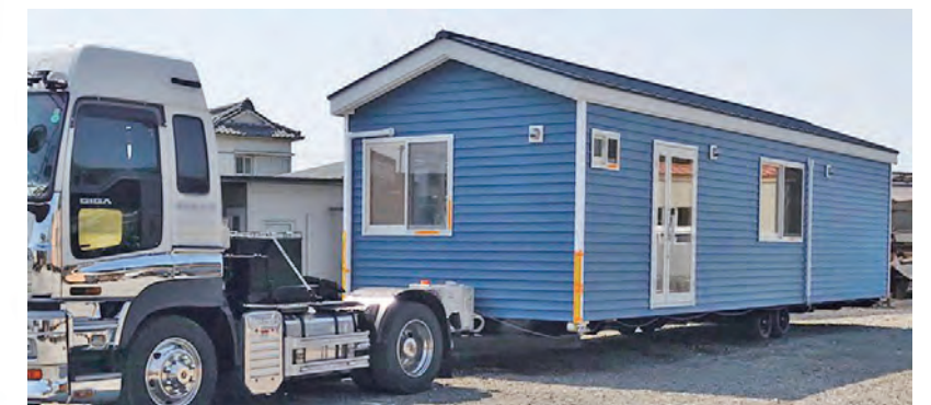
基準緩和認定を受け、かつ特殊車両通行許可の認定を受けたトレーラーハウス
