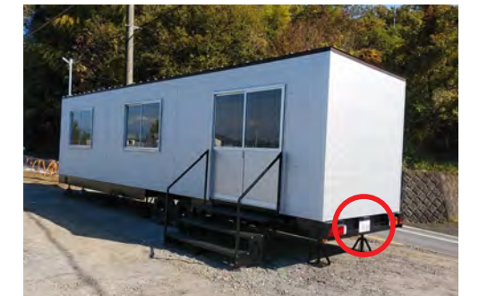
車検取得しナンバープレートを取り付けたトレーラーハウス
